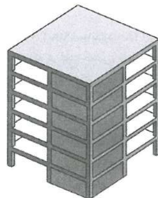
▲ شکل ۱۲- ستون‌هایی که در محل تقاطع دو و یا چند سیستم مقاوم باربر جانبی قرار دارند
